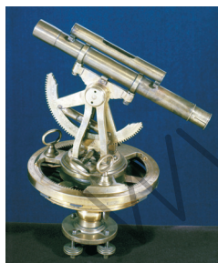
Slika 2.2. Teodolit, 4,5 inča, altazimut, sredina 18. st.
