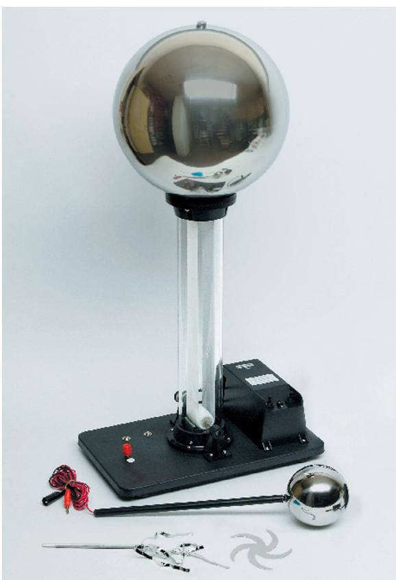
Uređaj za generiranje električnih naboja za izvođenje pokusa iz elektrostatike.
