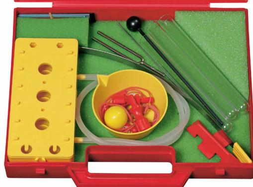
Sadržava višenamjenski pribor, uključujući glazbenu kutiju, zvučnu vilicu, epruvetu, zvučnu pločicu, napinjač žice, gumene kolotove, opružne trake i ušne cijevi s pomoću kojih se može izvesti 8 osnovnih pokusa iz područja akustike.
