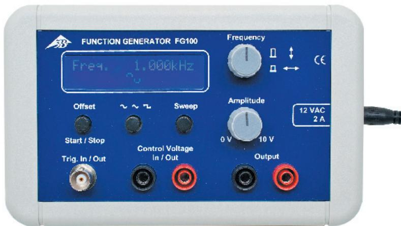
Željena funkcija uređaja se odabire s pomoću prekidača, a potom se tipkama vrše podešavanja frekvencije, amplitude i valnog oblika signala. Za ulazni/izlazni signal uređaj posjeduje BNC utičnicu, a za kontrolni ulazni napon i izlaznu snagu utičnice od 4 mm.
