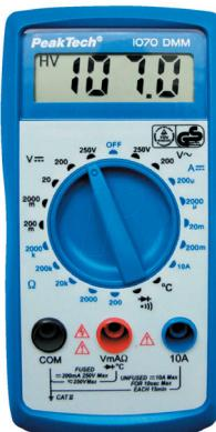
Višenamjenski mjerni uređaj s LCD zaslonom i prekidačem za ručno namještanje mjernog područja koristi se za mjerjenje istosmrjene struje, istosmjernog i izmjeničnog napona, otpora i temperature, te ispitivanje dioda i tranzistora.
