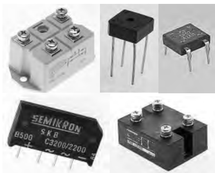
Slika 2.13. Ispravljač u jednom kućištu
