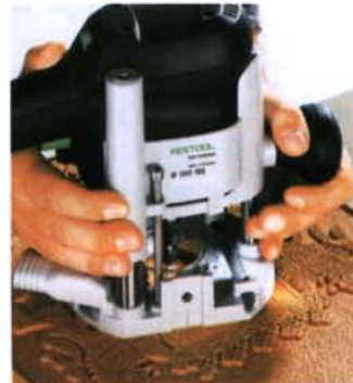
Slika 3.45. Ručna nadstolna glodalica vodi se pri glodanju objeručke
