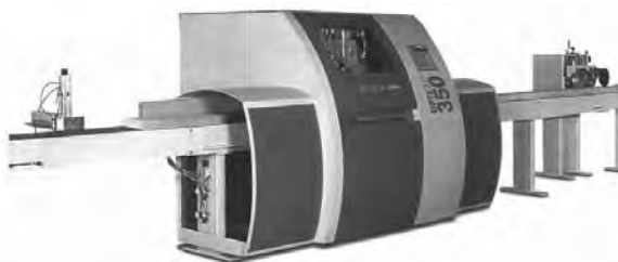
Slika 3.59. Računalom upravljana kružna klatna pila s opslužnim transporterima (Grecon-Dimter)
