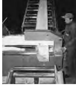
Slika 3.57. Jedan tip dubeće kružne klatne pile sa pojednostavljenim shematskim prikazom principa rada
