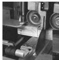
Slika 3.60. Obradak u zahvatu posmično-pritisnih valjaka elektronički upravljanih klatnih kružnih pila (Grecon-Dimter)
