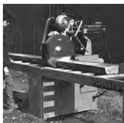
Slika 3.56. Jedan tip viseće kružne klatne pile sa dva posmična klatna: a) prikaz stroja (Forestor), b) shematski prikaz principa rada
