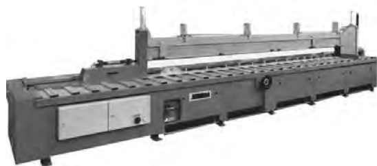
Slika 3.48. Jedan tip jednolisne kružne pile za uzdužno raspiljivanje piljenica s automatskim posmičnim gibanjem alata (Jrion): 1. postolje, 2. radni alat, 3. tlačna letva, 4. radni stol (list kružne pile), 5. uređaj za odstranjivanje piljevine, 6. vodičica, 7. upravljački uređaj
