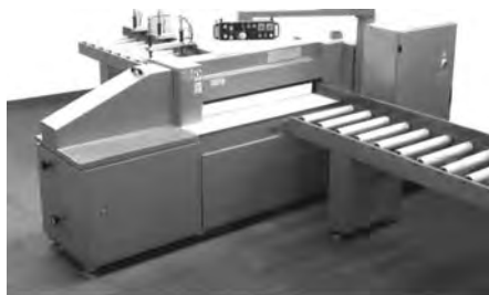
Slika 3.54. Jedan tip podizno-potezne kružne pile za poprečno raspiljivanje piljenica (Salvador)
