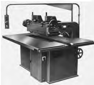
Slika 3.47. Jedan tip jednolisne kružne pile za uzdužno raspiljivanje piljenica s automatskim posmičnim gibanjem obratka (Bratstvo) s pojednostavljenim shematskim prikazom radnog i posmičnog gibanja: 1. radni stol, 2. člankasti transporter za posmak obratka, 3. lančanik s pogonskim motorom člankastog transportera, 4. pritisno posmični valjci, 5. obradak, 6. vratilo s radnim alatom i pogonskim elektromotorom, 7. vodilica obratka, 8. protupovratni uređaj, 9. vodilica člankastog transportera.
