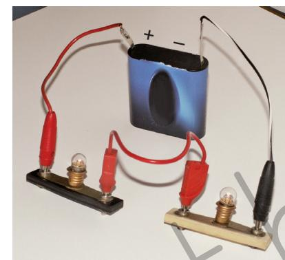
Slika 10. Strujni krug s dvjema žaruljama spojenim u serijski spoj s izvorom
