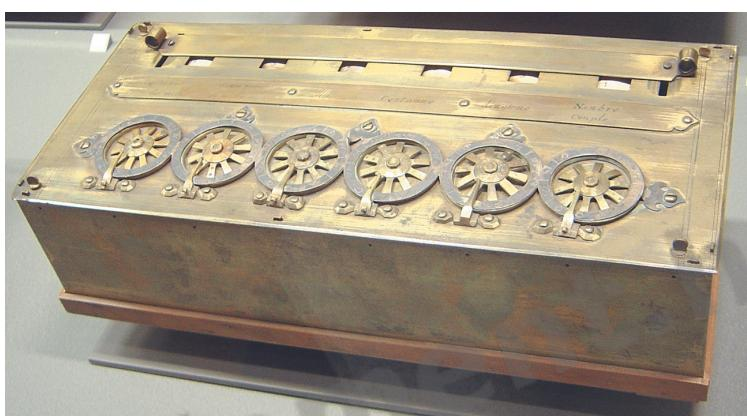
■ Slika 1.7. Mehanički računski uređaj "Pascaline"
