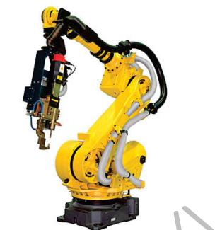
c) robot za elektrootporno zavarivanje
