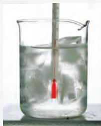
**Postupak:** Čašu napunite usitnjениm ledom i pažljivo stavite termometar u led. Odčitajte i zabilježite temperaturu. Zatim postavite čašu s ledom na željezni tronožac sa staklokeramičkom pločicom i kratko vrijeme zagrijavajte.
