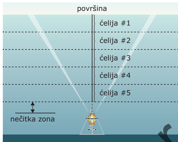
Slika 2.26. Shematski prikaz rada akustičkog strujomjera postavljenog na dno mora (prema: Aanderaa Instruments, 1996).
