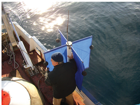
Slika 2.21. Površinski drifter prije otiskivanja s istraživačkog broda Bios u studenom 2002. godine ( lijevo ) te u moru ( desno , iz autorove arhive).
