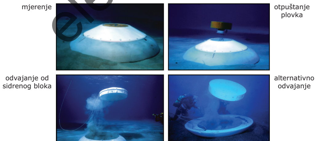
Slika 2.27. Jedan način postavljanja akustičkog strujomjera na dno mora i njegovog vađenja iz mora (uređaj su razvili H. Perkins et al. , 2000).
