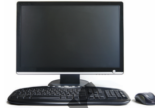
Slika 1.9. Računalo s integriranim kućištem (engl. all in one )
